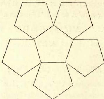
pentagone, et si l'on réunit, par une bandelette de papier, les arêtes issues d'un même sommet, pour les pentagones extérieurs, on forme ainsi une sorte de corbeille (*fig. 92*). On construit une seconde corbeille égale à la première ; ces deux corbeilles peuvent s'emboîter l'une dans l'autre, le long des arêtes extérieures, et l'on forme un polyèdre régulier que l'on nomme *dodécaèdre régulier*.
